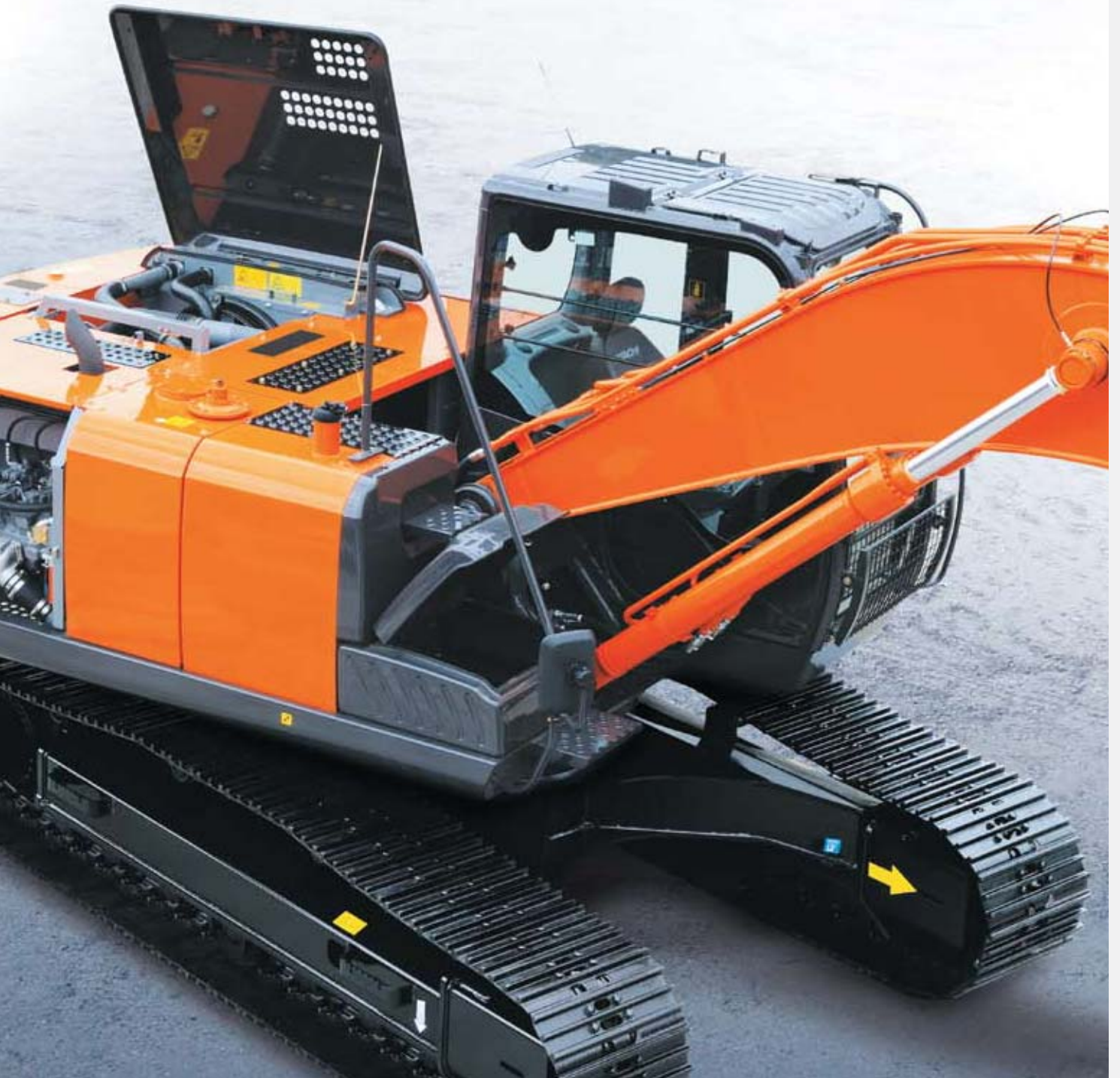
На иллюстрации показан экскаватор с нижней защитной решеткой лобового стекла, устанавливаемой по заказу.
